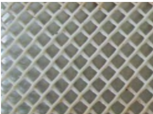
Figura 1. Mallas de plástico de alta densidad de color blanco con orificios de 3,4 x 3,2 mm y un espesor de 1,3 mm.
